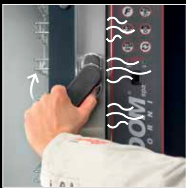
Porta apribile tramite l'utilizzo di una maniglia a due stadi: il primo permette la fuoriuscita del vapore (1° STEP), il secondo fa aprire del tutto la porta (2° STEP). Door can be opened using a two-stage handle: the first allows steam to exit from the oven (1st STEP), while the second opens the door completely (2nd STEP).
